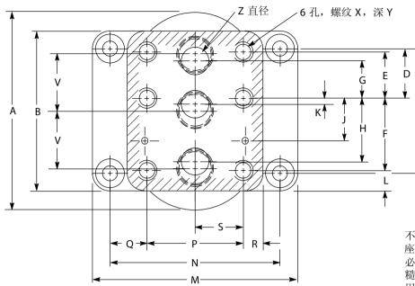
不使用底板时,必须提供机加工的安装座(如阴影区域所示),安装座的平面度必须在 0,013 mm (0.0005 in) 以内,粗糙度必须在 1,6  $\mu$ m (63  $\mu$  in) 以内。由用户提供的安装螺栓应当是 12,9 级 (ISO 898) 或更好。
