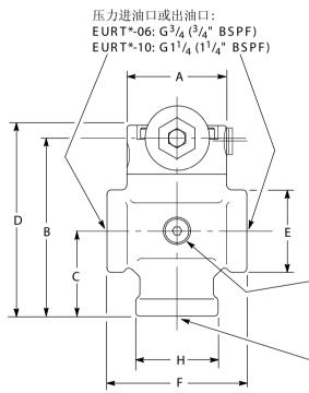
用于使泵卸载的先导压力油口, G <sup>1</sup>/<sub>4</sub> (<sup>1</sup>/<sub>4</sub>" BSPF)
